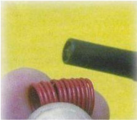
La otra, desenróllela y utilícela como antena, se preguntará por que se sigue este procedimiento que parece ilógico, la razón es que de esta forma se asegura que la separación entre las espiras es la necesaria y que es igual entre ellas así el transmisor funcionará correctamente.
